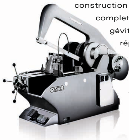
Encore très utilisée : La scie alternative EBS des années 60.
